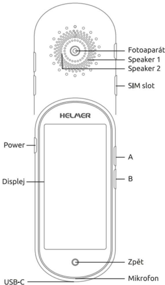
Zapnutí/Vypnutí překladače: podržení tlačítka Power
